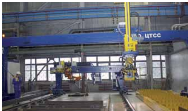
Портал для механизированной установки и прихватки ребер жесткости на полотна микропанелей
